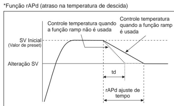
Ele controla a diminuição da temperatura como mostrado acima: O tempo rPAd não pode ser inferior que o tempo de descida (td)(quando a função rampa não é utilizada)
