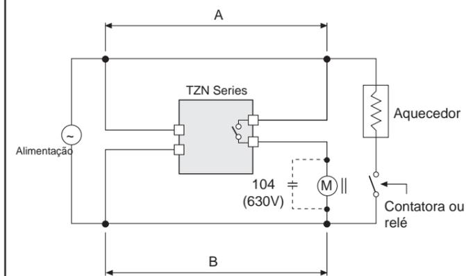
1. Mantenha o relé externo/contatora tão longe quanto possível do controlador TZ/TZN. Se o comprimento de A for pequeno, pode ocorrer interferência do chaveamento do relé na alimentação do TZ/TZN causando mal funcionamento.
