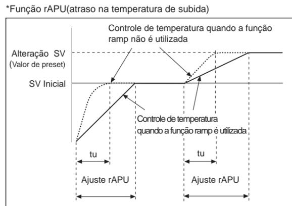
Ele causa um atraso na subida da temperatura. O tempo rAPU não pode ser inferior que o tempo de subida da temperatura (tu) (quando a função rampa não é utilizada)
